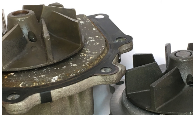
Obrázek 1: Posunutá lopátkové kolo se stopami opotřebení (vlevo), správná poloha lopátkového kola (vpravo)
