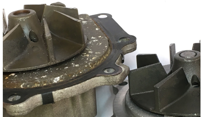
Εικόνα 1: Μετατοπισμένη φτερωτή με ρωγμές (αριστερά), σωστή θέση φτερωτής (δεξιά)
