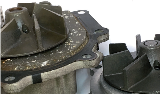
איור 1: מאיץ שזו ממקומו עם חריצים (שמאל); מצב נכון של המאיץ (ימין)
