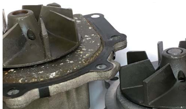
Slika 1: Prikaz neispravnog i istrošenog rotora (lijevo); prikaz ispravnog rotora (desno)
