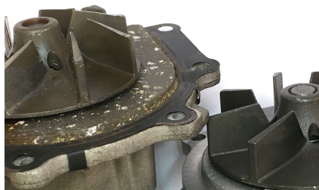
Figura 1: La girante con tracce di scorrimento (sx), sede corretta della girante (dx)
