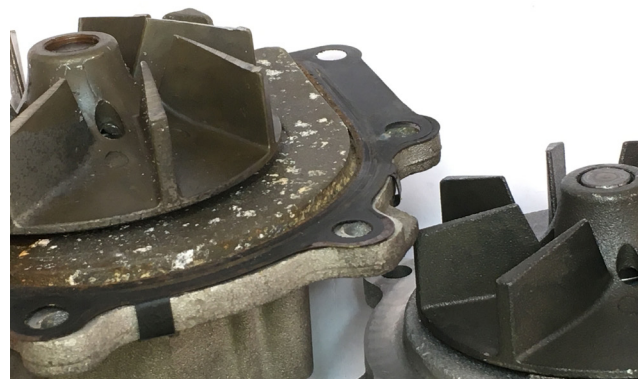
Afbeelding 1: Vershoven schoepenrad met aanloopsporen (links), correcte zitting van het schoepenrad (rechts)
