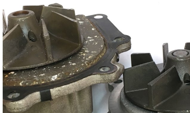
Fig. 1: Impulsor deslocado no eixo e com marcas nas alhetas devido ao contato com o bloco do motor (lado esquerdo), impulsor corretamente posicionado (lado direito)
