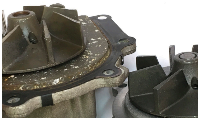
Fig. 1: Rotor deplasat cu zgârietură (stânga); poziția corectă a rotorului (dreapta)
