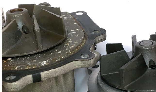
Slika 1: Neispravno i istrošeno radno kolo (levo); ispravno radno kolo (desno)
