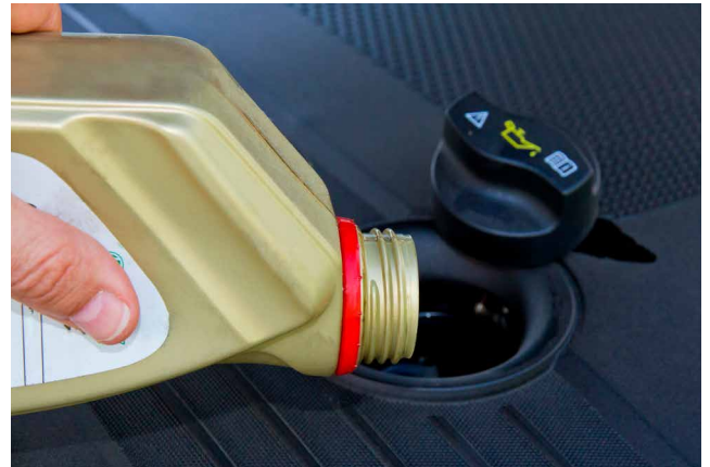
Afbeelding 1: Ongeschikte motorolie leidt tot voortijdig falen van de distributieriem
