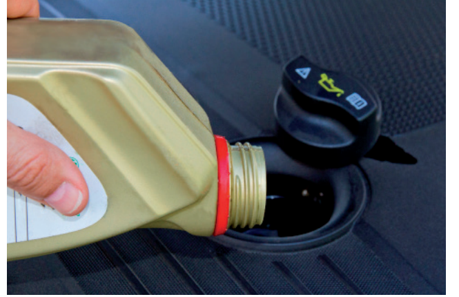
Şekil 1: Uygun olmayan motor yağı, triger kayışının erken aşınmasına neden olacaktır
