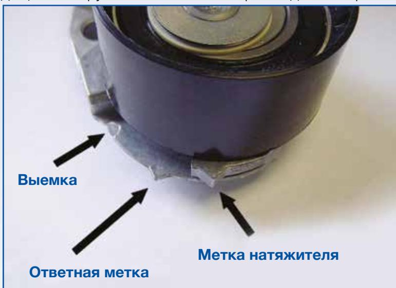
**Ни в коем случае не воздействуйте каким-либо инструментом непосредственно на натяжитель в сборе как для его удержания, так и для регулировки ролика натяжителя. Это может привести к преждевременному выходу из строя натяжителя в сборе и отказу в гарантии.**
