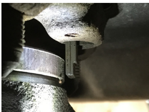
Fig. 2 disco freno e sensore installati correttamente
