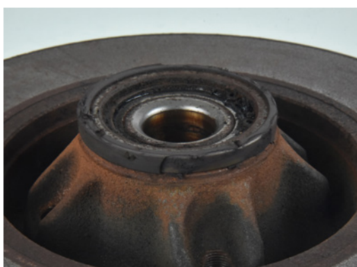
Fig. 1 Corona danneggiata dovuto al contatto con il sensore
